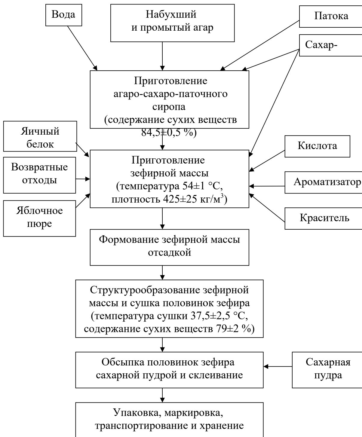
Рис. 1. Технологическая схема производства зефира на агаре
